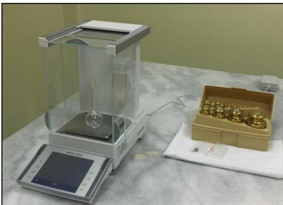
Fig. 14 Balanza para calibrar
