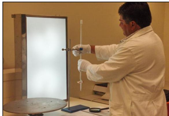
Fig. 15 Calibración de recipientes volumétricos
