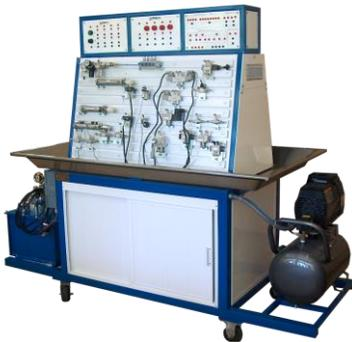
Fig.3 Banco de practicas hidráulico neumáticas
