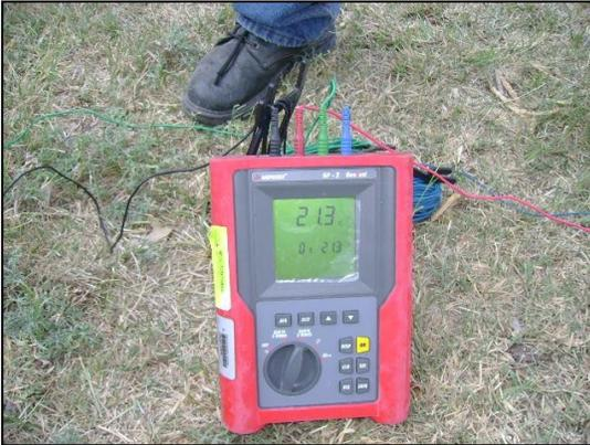
Fig. 9 I.T. Apatzingan. Terrómetro.
