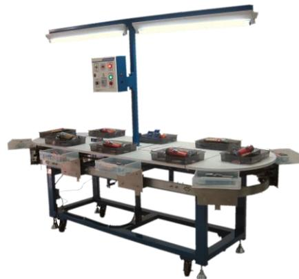
Fig. 4 Transportador de cadena
