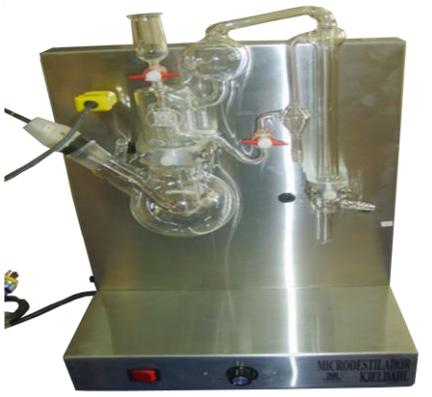
Fig.5 y 6 Destilador y destilador Kjendalh
